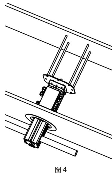
4、将吊装丝杆螺丝上旋或者下旋，调整设备高度，使装饰圆盘与装饰天花齐平，如图5所示
