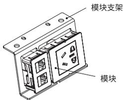
步骤三：根据对应线缆接上相应模块接口，并卡入模块支架。
