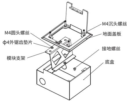
步骤一：拧下4颗M4沉头螺丝、3颗M4圆头螺丝及接地螺丝，取出1颗φ4外锯齿垫片、地面盖板及模块支架。
