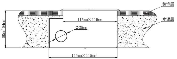
步骤二：气泡袋平铺于底盒内表面后，将底盒固定于相应位置，将各种导线通过线管引入底盒并至少预留180mm；浇筑完成后，底盒底部与地面装饰材料表面距离(80~84)mm。
