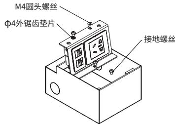
步骤四：用3颗M4圆头螺丝及1颗φ4外锯齿垫片将接好线缆的模块支架固定在底盒上，并接地。
