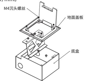
步骤五：用4颗M4沉头螺丝将地面盖板固定在底盒上，边缘压住地面装饰材料。
